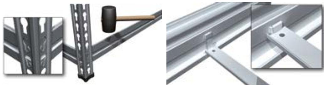
5. В случае, если стеллаж комплектуется металлическим настилом, по центру продольных балок необходимо установить стяжки. Для этого необходимо установить стяжку на нижние отгибы балок, которые при этом должны немного выгнуться.
